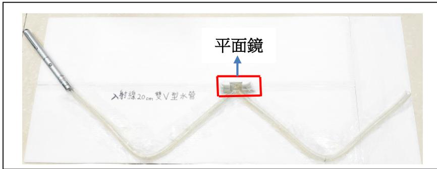
圖 3-6-1: 完成「雙 V 型導光水管裝置」
