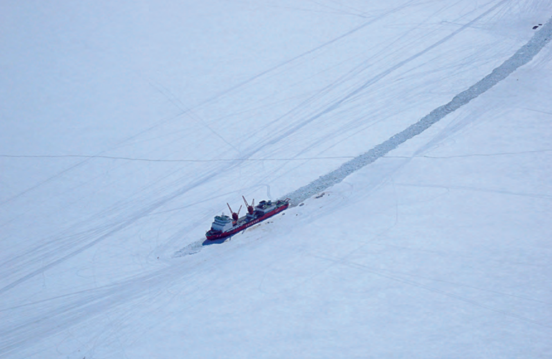
雪龍號真正的破冰：直接將船開到冰面上，用蠻力鑿出一條航道。
