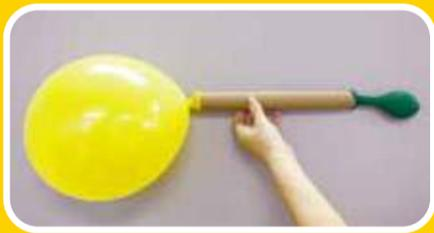
因為大氣球的橡皮撐大，所以推擠空氣的力量變弱了。小氣球推擠空氣的力量較強，會迅速將空氣推出去。結果，小氣球的空氣進入大氣球裡，於是小氣球縮小，大氣球變大了。
